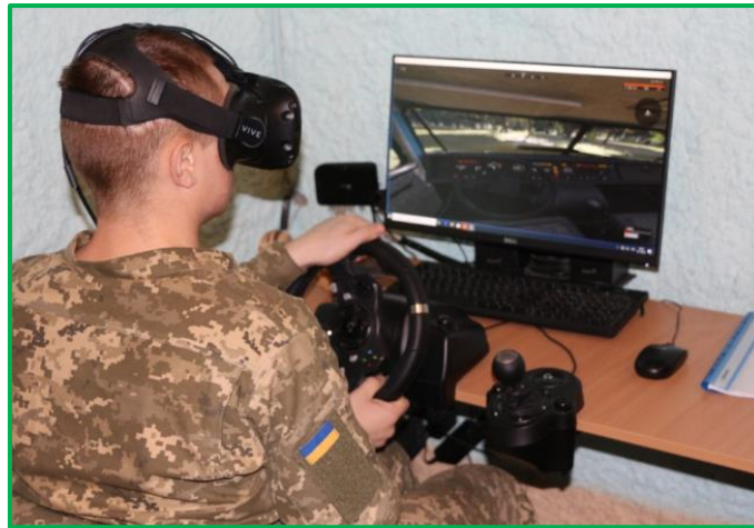
Рисунок 1.4 – Динамічний віртуальний тренажер для водіїв-механіків [10].
