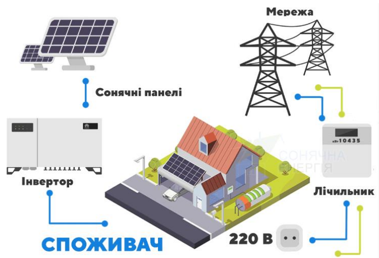
Рисунок 2.2 – Принципова схема встановлення сонячної електростанції [21]
