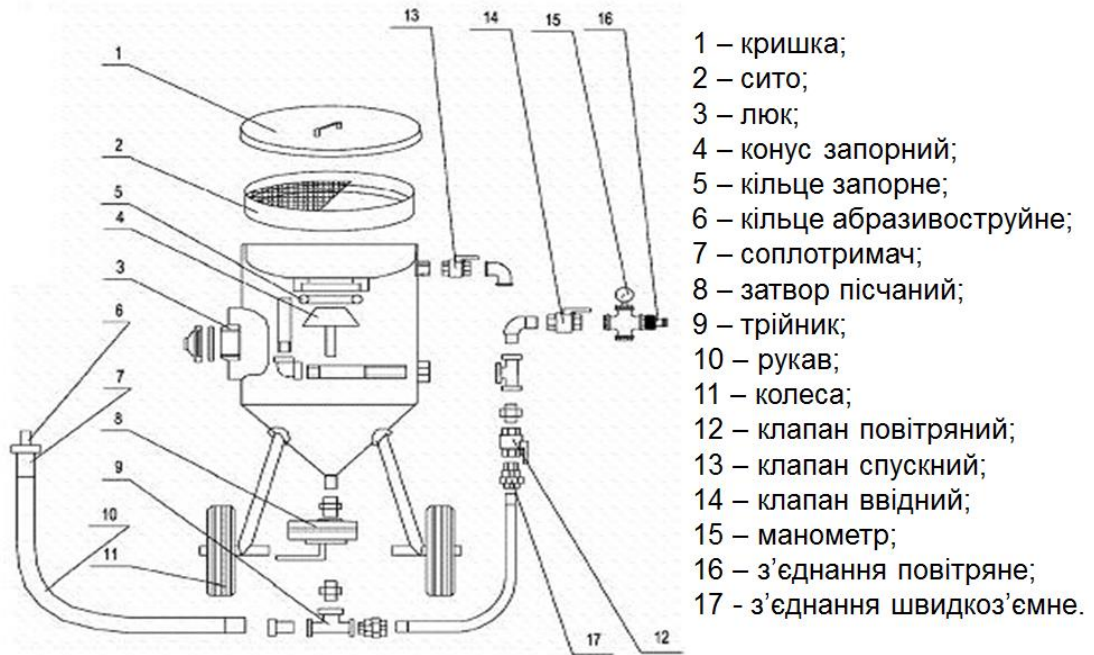
Рисунок 1.1 – Схема ежекторно-очисної установки
