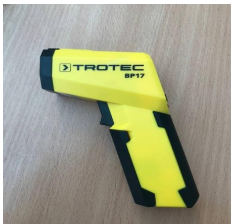
Рисунок 1.5 – Безконтактний пірометр TROTEC (BP17)
