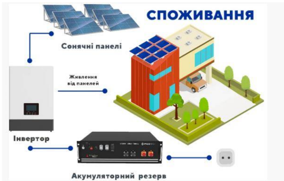
Рисунок 2.2 – Принципова схема встановлення сонячних панелей [20]
