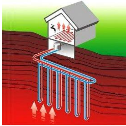
Рисунок 2.4 – Принципова схема розміщення теплового насосу [19]
