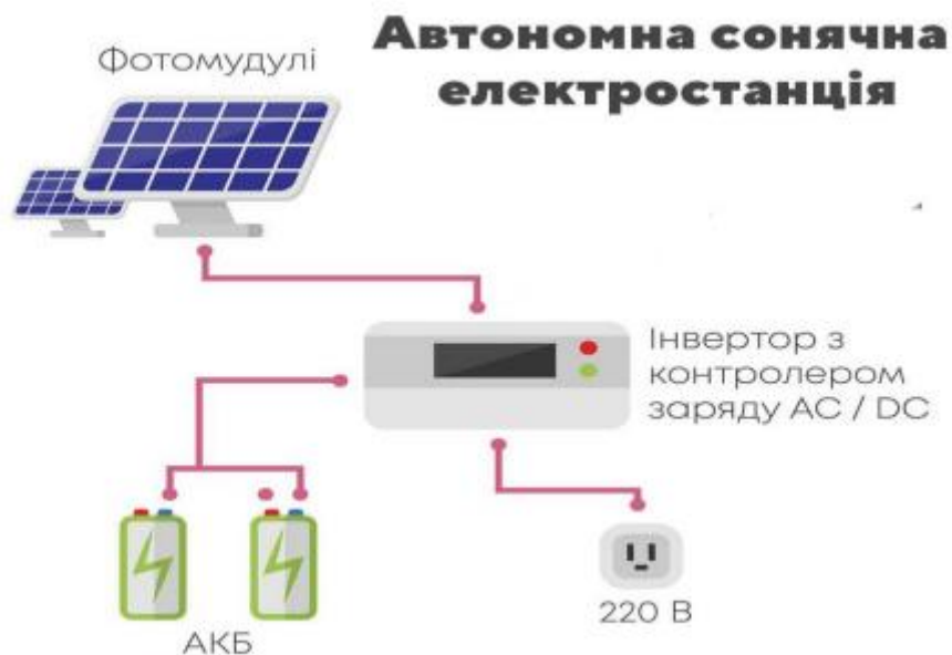
Рисунок 2.4 – Принципова схема автономної електростанції[20]
