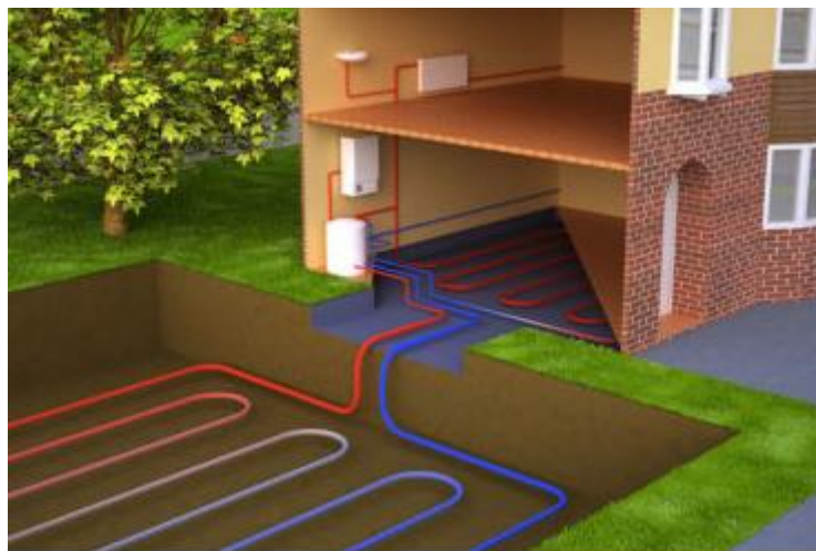
Рисунок 2.3 – Принципова схема розміщення теплового насосу [20]
