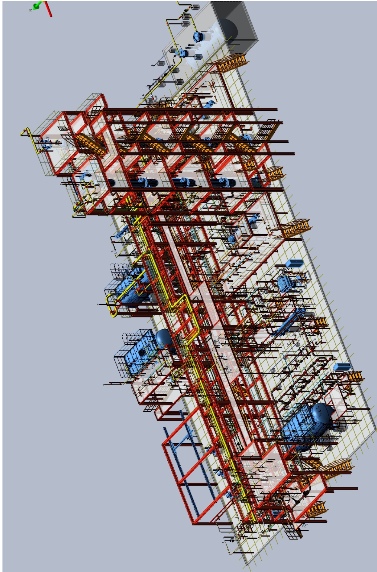
Рисунок 4.6 – Тривимірна модель відділення стабілізації конденсату з трасуванням трубопроводів
