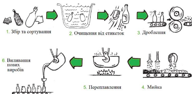
Рисунок 9.1 – Схема технології перероблення скла
