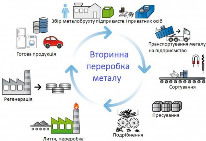
Рисунок 8.5 – Схема перероблення металів та сплавів
