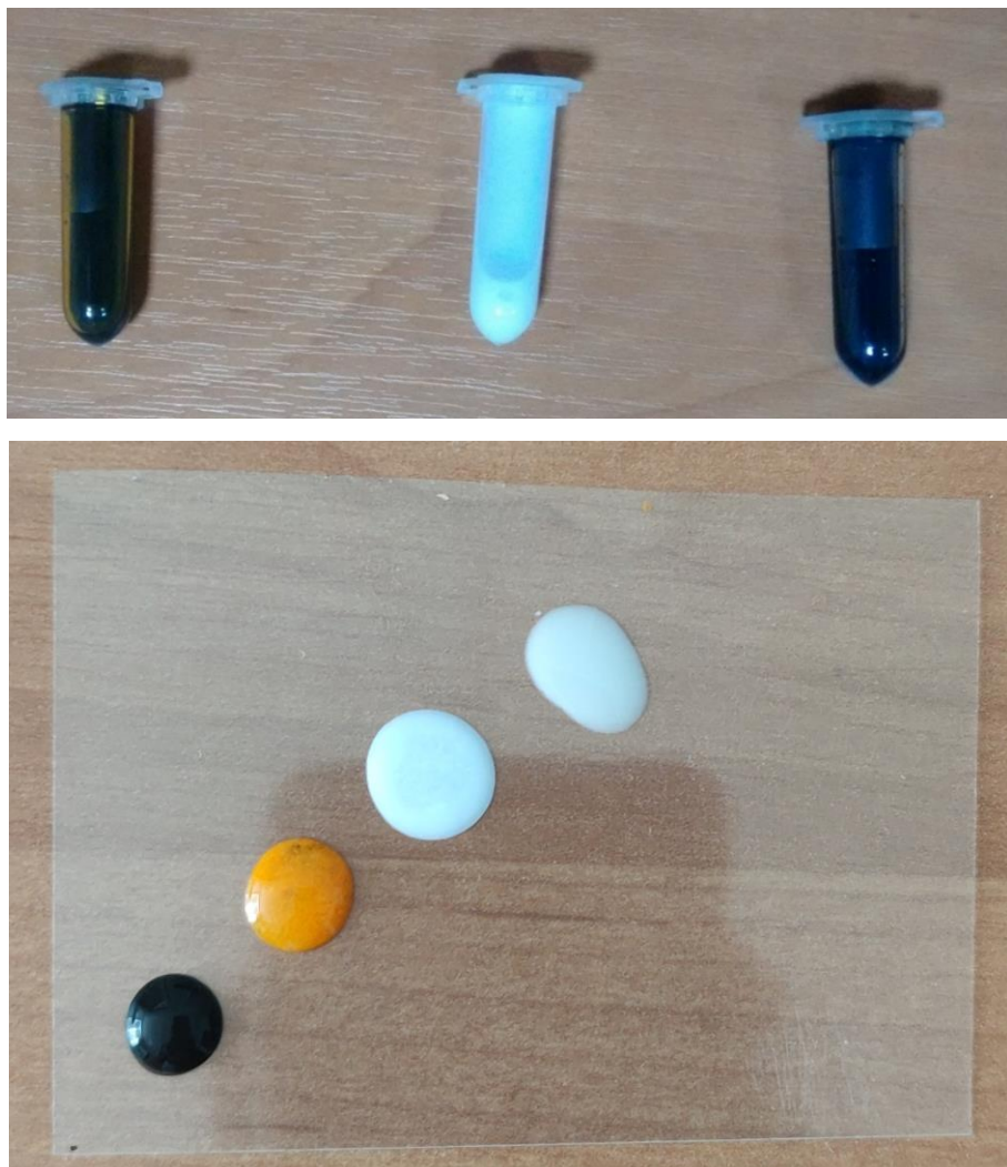
Рисунок 2.5 – Суспензії синтезованих наночастинок \text{Cu}_2\text{ZnSnS}_4 , ZnO, \text{Cu}_2\text{ZnSnSe}_4 після заміщення ПАВ (а) та краплі чорнил \text{Cu}_2\text{ZnSn}(\text{S}_x\text{Se}_{1-x})_4 , CdS, ZnO, ZnO:In на скляній підкладці (б)
