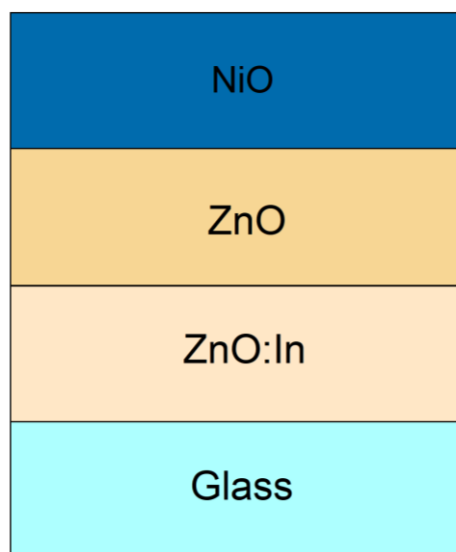
Рисунок 5.1 – Схематичне зображення багатошарової структури скла/ZnO(1% In)/n-ZnO/p-NiO
