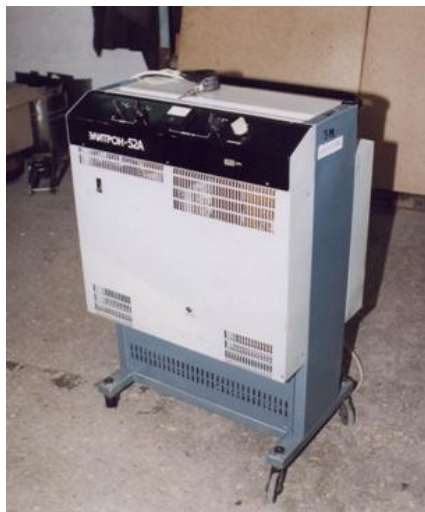
Рисунок 2.1 – Установка «Елітрон-52А» для проведення ЕІЛ
