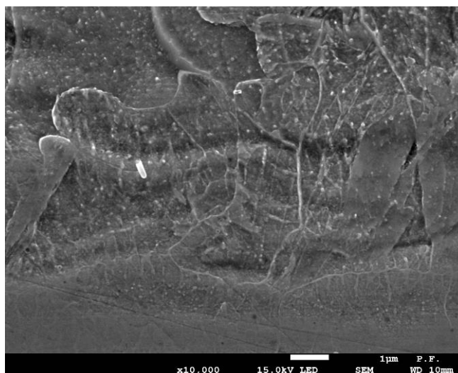
Рисунок 3.14 – Мікроструктури покриттів на зразках із армко заліза після ЕІЛ молібденом, отримане при W_p = 0,13 Дж, без СТС
