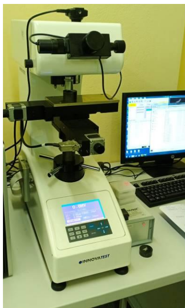
Рисунок 3.3 – Фото твердоміру NOVA 330/360
