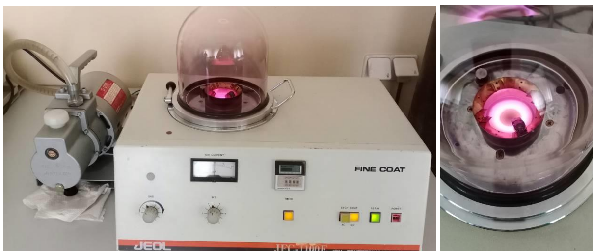
Рисунок 3.5 – Фото іонно-напилювального пристрою JFC-1100E
