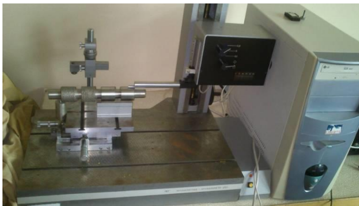
Рисунок 3.2 – Визначення шорсткості на приладі профілограф-профілометр мод. 201 заводу «Калібр»
