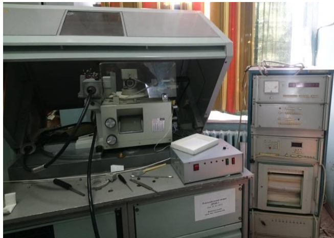
Рисунок 2.4 – Фото дифрактометру ДРОН-3
