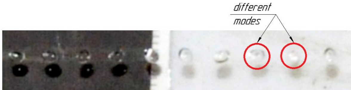
Рисунок 3.16 - Розпад струменя на краплі за частоти 510 Гц
