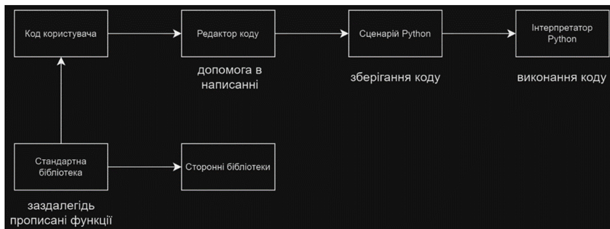
Рисунок 3.3 – Спрощена блок-схема роботи Python
