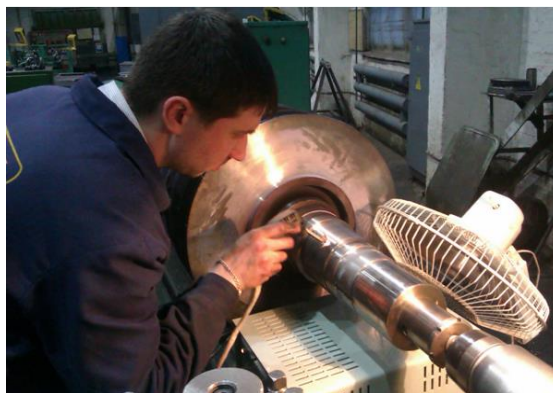
Рисунок 6.4 – Нанесення методом ЕІЛ на підшипникову шийку валу відцентрового компресора приробітного покриття
