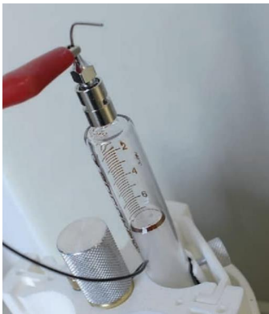
Рисунок 3.3 – Електрод під'єднаний до голки шприця
