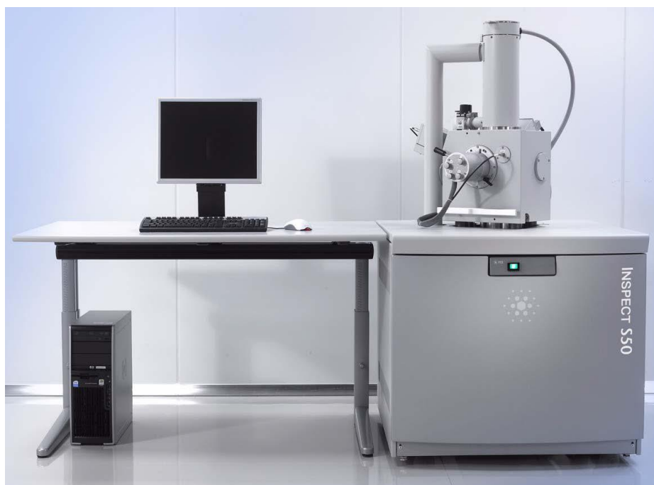
Рисунок 2.4 – Скануючий електронний мікроскоп SEO-SEM Inspect S50-B
