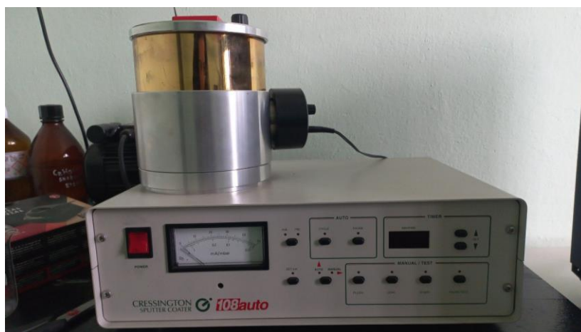
Рисунок 2.5 – Апарат для нанесення покриття Cressington 108auto
