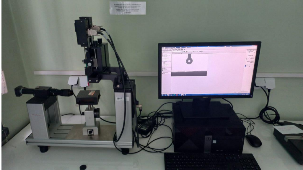
Рисунок 2.7 – Гоніометр data physics OCA 15EC
