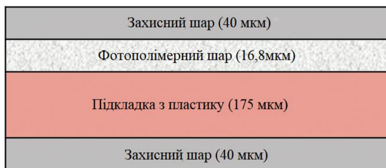
Рисунок 2.9 – Структура плівки Bayfol NX 102
