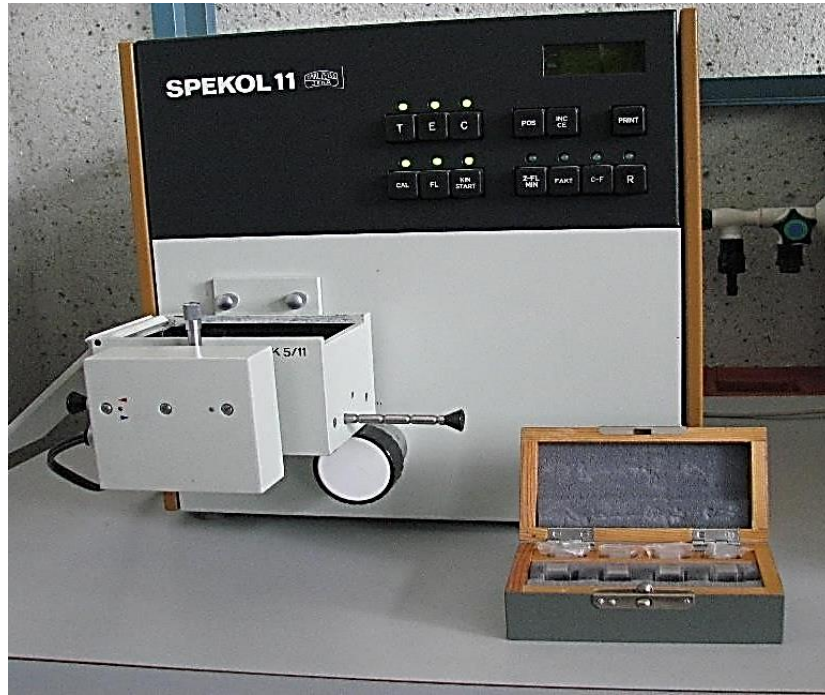
Рисунок 2.1 – Спектрофотокolorиметр «Спекол–11» (Німеччина)
