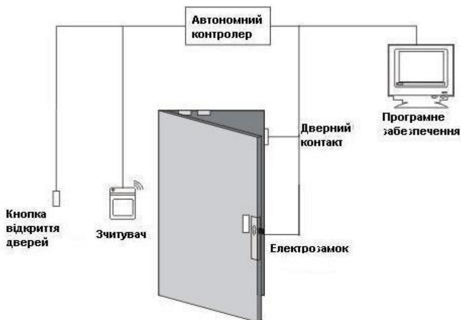
Рисунок 1.11 – Схема пристрою системи контролю та управління доступом.
