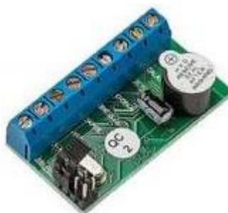
Рисунок 1.9 – Автономний контролер СКУД Z-5R 5000. Із роботи [7]
