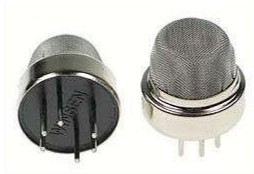
Рисунок 1.4 Зовнішній вигляд датчика MQ-2. Адаптовано з роботи[25]
