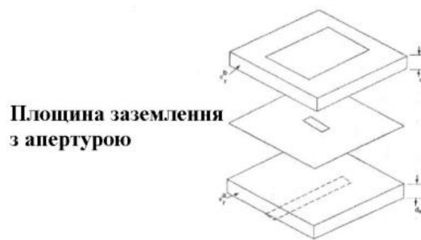
Рис. 4. Живлення мікросмушкового резонатора за допомогою щілинної апертури
