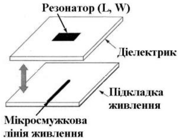
Рис. 3. Живлення мікросмужкового випромінювача за допомогою ємнісного зв'язку мікросмужкової лінії і резонатора
