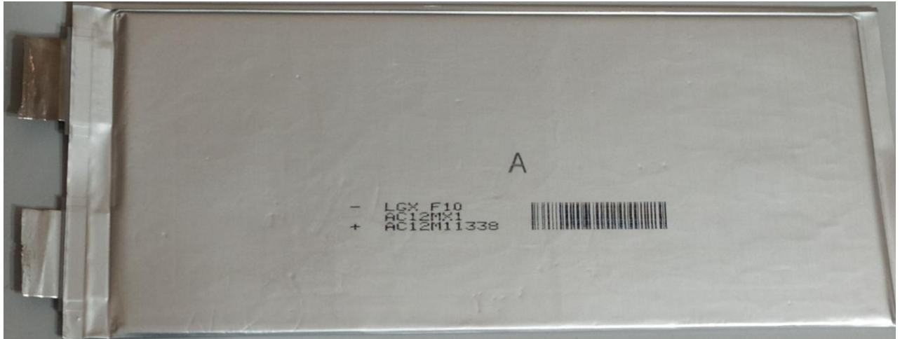
Рисунок 3.3.1 – Літійовий полімерний акумулятор LG F10 10Ан 3,7 В
