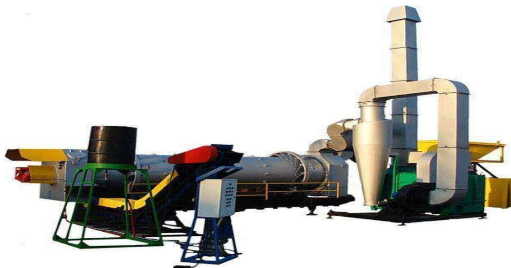
Рисунок 1.2 – Установка для утилізації замазучених ґрунтів (УЗГ- 1М) (фото В.С. Міщенко)
