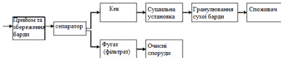
Рисунок 3.5 — Схема переробки післяспиртової барди з сепаруванням і фільтрацією
