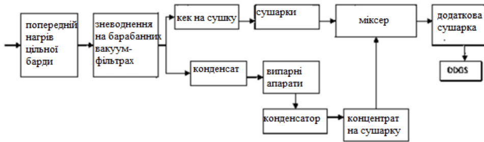
Рисунок 3.6 — Схема переробки післяспиртової барди з «упарюванням фугату» у випарних станціях
