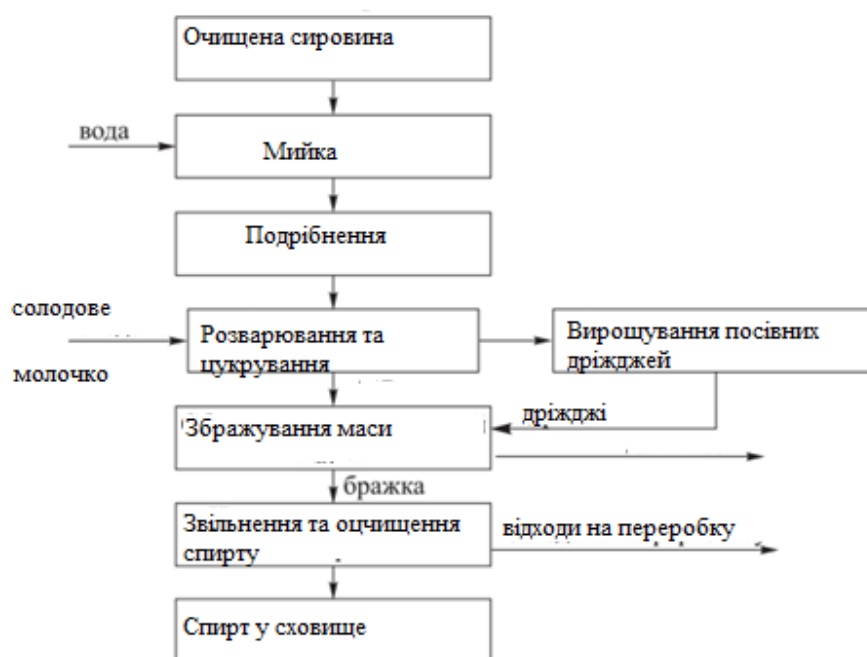
Рисунок 1.5 — Функціональна схема технологічного процесу отримання спирту [16]
