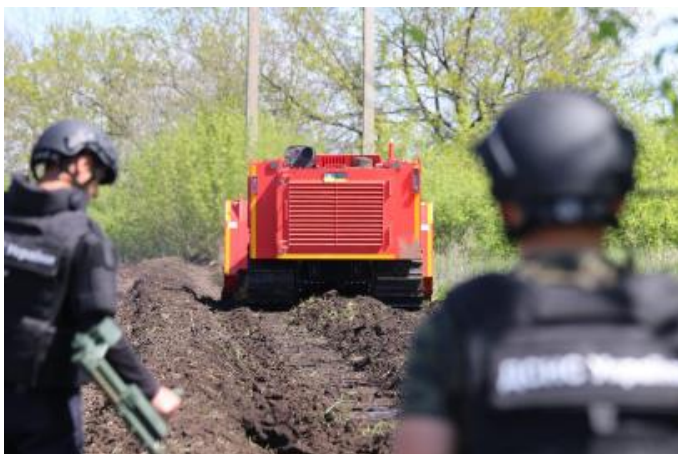
Рисунок 2.1 – Процес розмінування земель з залученням саперів та машини для знешкодження вибухонебезпечних предметів [15]
