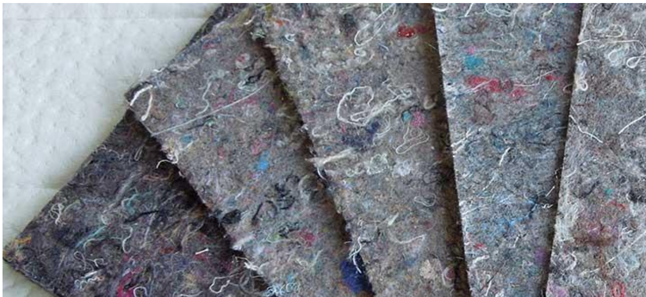
Рисунок 2.6 – Використання переробленого текстилю для наповнювачів, шумоізоляційних матеріалів та в якості теплоізоляції [33].
