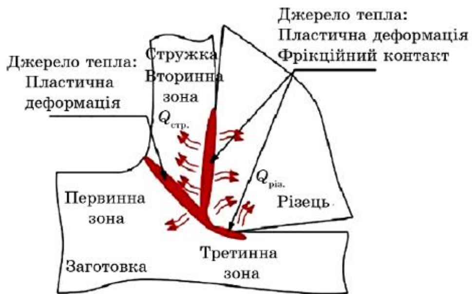
Рисунок 7 – Основні джерела тепла під час формування стружки при механічному обробленні [78]
