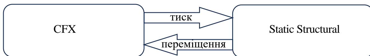
Рисунок 2.3 – Схема взаємодії вирішувачів ANSYS Structural і CFX
