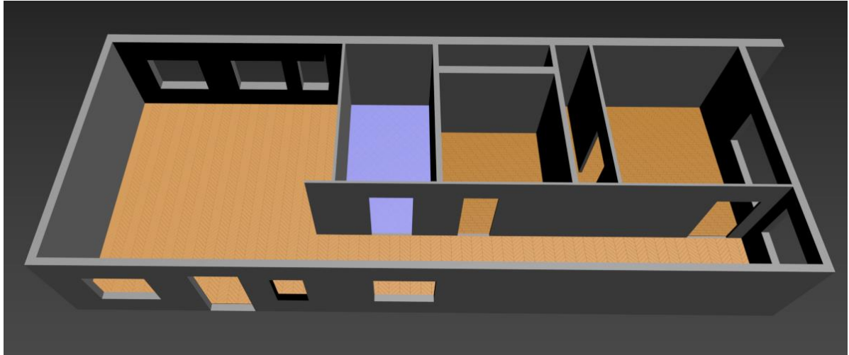
Рисунок 3.7 – Створення отворів для вікон та дверей
