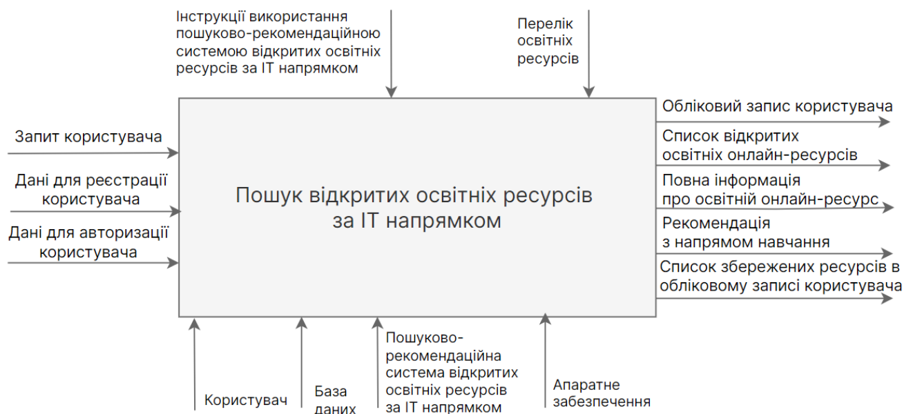
Рисунок 2.1 – Контекстна діаграма нотації IDEF0 з точки зору користувача
