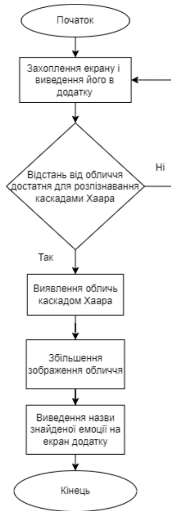
Рисунок А.3 – блок-схема алгоритму розпізнавання емоцій на обличчі
