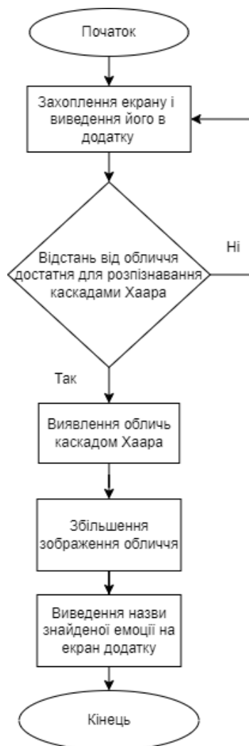
Рисунок 1.8 – Схема алгоритму визначення емоцій на обличчі
