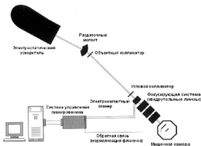
Рисунок 4 - Схема формирования сфокусированного пучка легких ионов средних энергий в ядерном сканирующем микросонде для целей технологии p-beam writing
