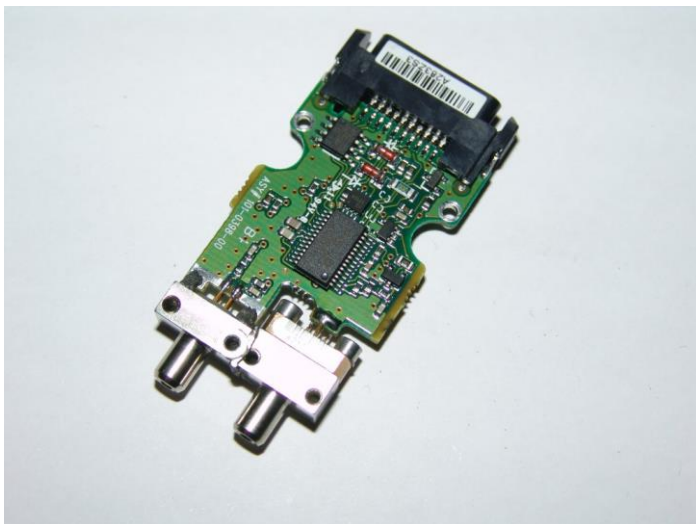
Рис.1.3. Модуль GBIC (показаний тут зі знятою кришкою) — це оптичний і електричний приймач, пристрій, що поєднує передавач і приймач в одному корпусі. Електричний роз'єм знаходиться вгорі праворуч, а оптичні роз'єми – унизу ліворуч [11]
