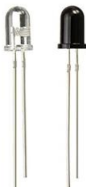
Рис. 3.4. світлодіод IR204-A (прозорий) та один фототранзистор PT204-6B (темний)
