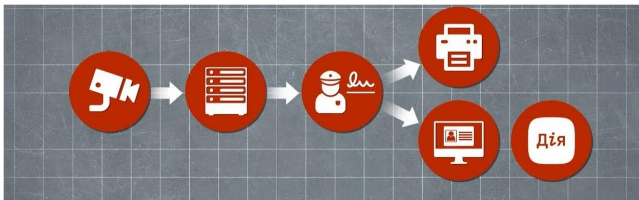
Рис.3 – Схема роботи системи автоматичної фіксації порушення ПДР [9].
