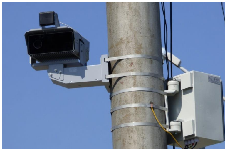
Рис.1 – Перший тип камери відеофіксації порушення ПДР [4].
