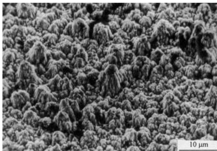
Рисунок 4.8 – SEM мікрофотографії поверхні, азотованої при 600 °С протягом 12 годин, що демонструє особливість будови поверхні.
