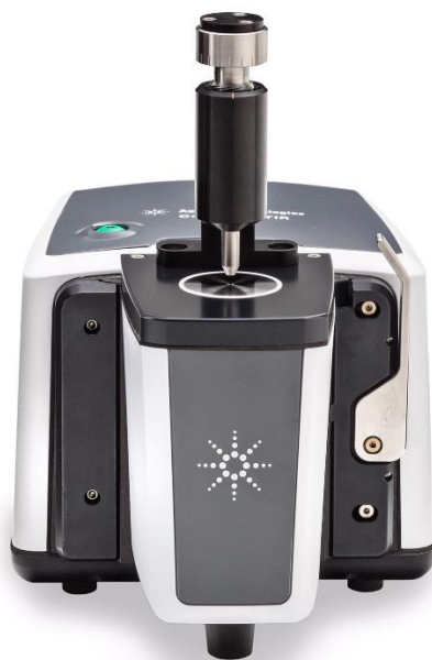
Рисунок 2.4. – Зовнішній вигляд ІЧ-Фур'є спектрометру моделі Agilent Carry 630 FTIR.
