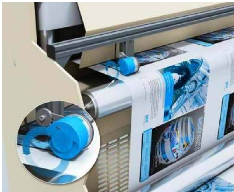
Рисунок 4.4 – Приклад використання енкодера з мірним колесом
