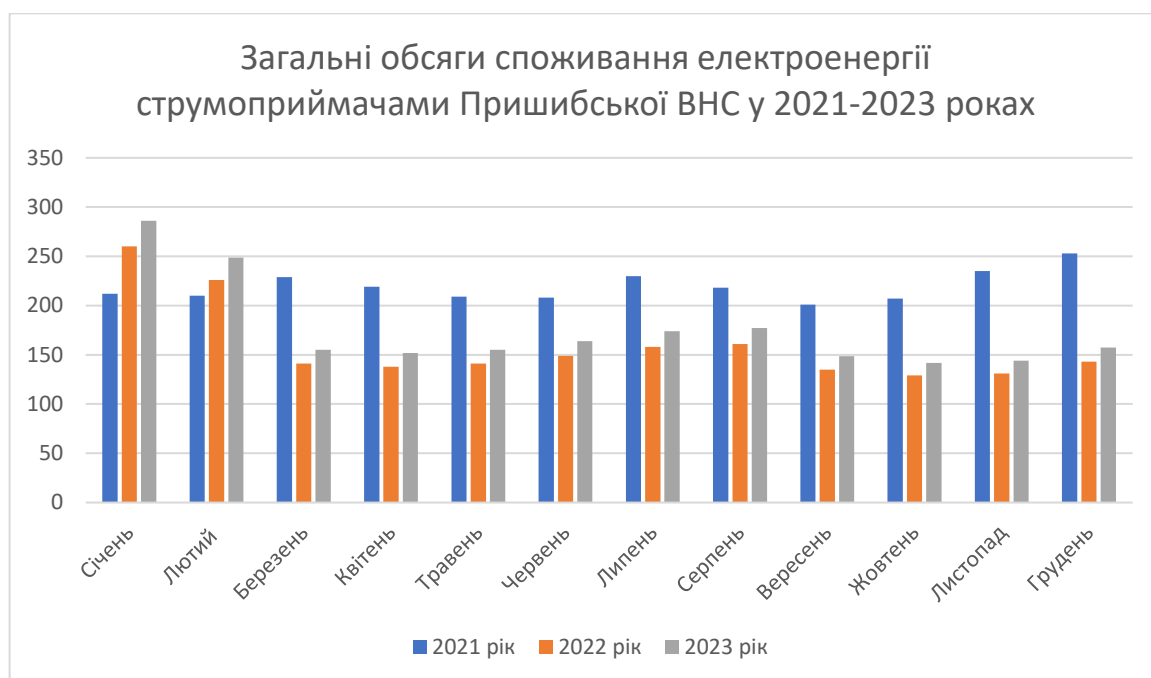
Рисунок 1.5 – Діаграма загальних обсягів споживання електроенергії струмоприймачами Пришибської ВНС у 2021-2023 роках
