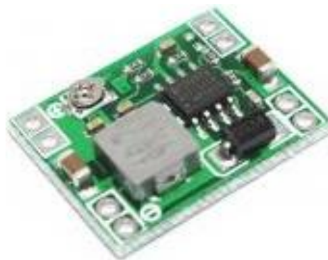
Рисунок 4.3 - Понижуючий перетворювач 5А на XL4015
