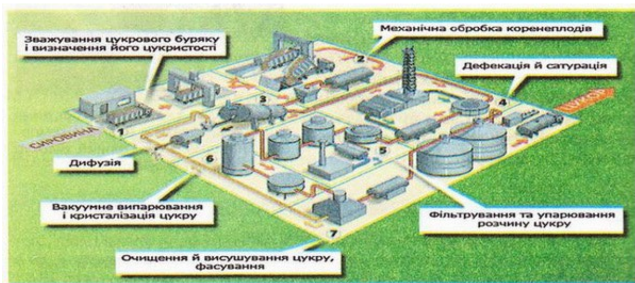
Рисунок 1.2 – Загальна схема виробництва цукру
