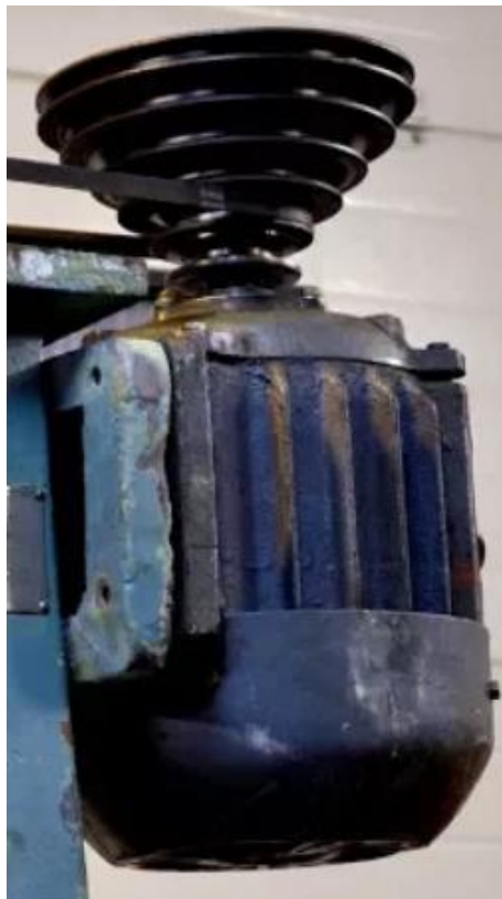
Рисунок 2.1 – Фото реального приводного вузла верстатат 2Н125 на верстаті
