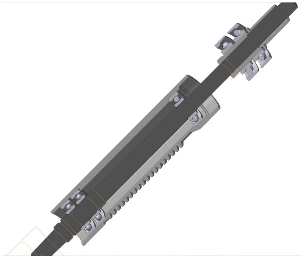
Рисунок 2.2 – 3D модель шпиндельного вузла верстатат 2М112
