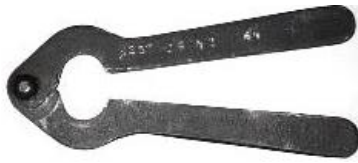
Рисунок 3.24 – Спеціальний ключ (лещатка) для згвинчування ковпачків підривника М-12
