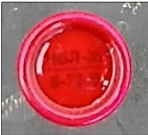
Рисунок 3.32 – Маркування основних зарядів 120-мм мін: НБЛ-34 – марка порошу; 8-72 – номер партії та рік виготовлення; Б – шифр заводу, на якому виготовлені заряди
