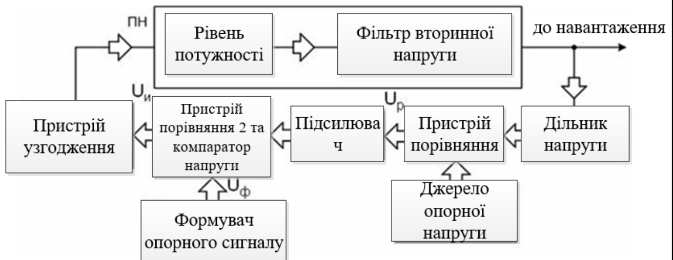
Рисунок 1 - Структурна схема ШІМ регулятора
