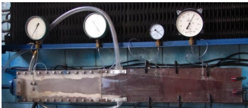
Рисунок 3.4 – Загальний вигляд прозорої моделі плоскопаралельного РПЕ
