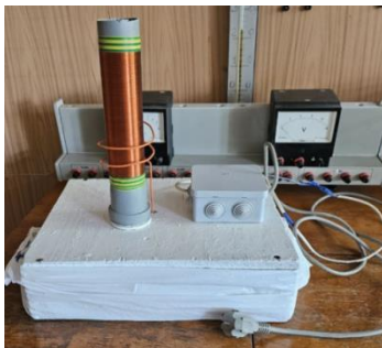
Фото 1 – Трансформатор Тесли, виготовлений на заняттях гуртка «Експериментаріум з хімії і фізики»
