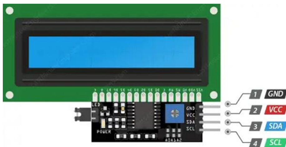
Рисунок 4.7 – Схема розташування виводів LCD1602 з I2C модулем.
