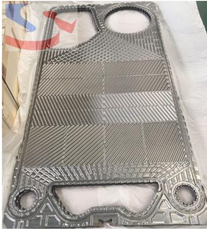
Рисунок 6 – Пластина з корозійностійких матеріалів
