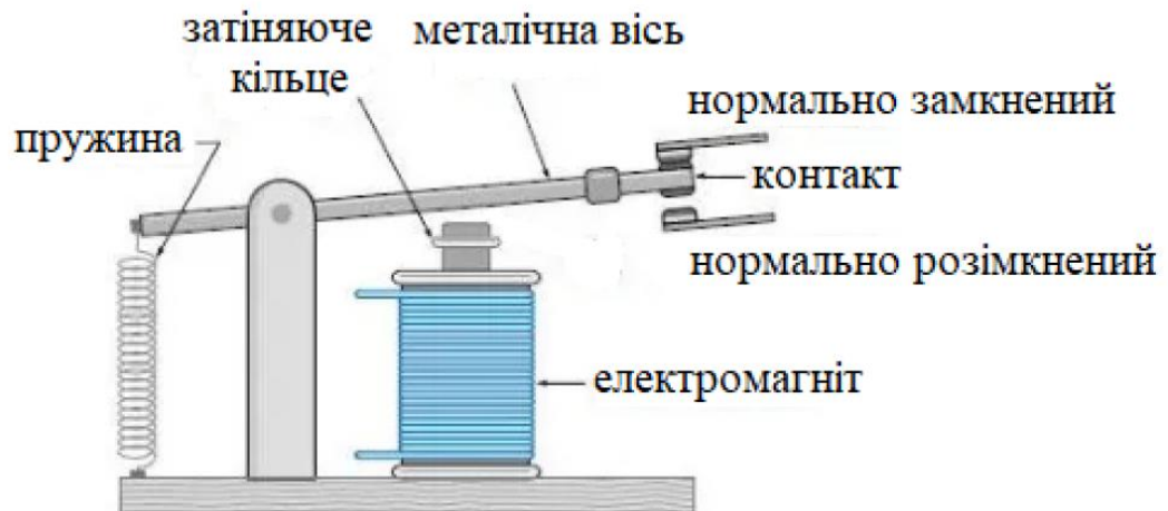
Рисунок 5.12 – Схематичне відображення роботи реле
