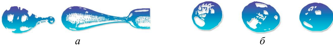
Рисунок 2 – Утворення рівномірних крапель без «супутників» під час накладання на струмінь регулярних імпульсів тиску від коливної мембрани:
