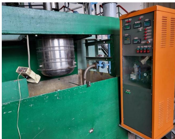
Рисунок В.1 – Зовнішній вигляд експериментального стенда обертового вібраційного гранулятора
