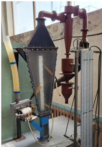
Рисунок Б.1 – Зовнішній вигляд експериментального стенда поличного багатоступеневого апарата зваженого шару
