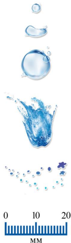
Рисунок 1.6 – Розпад краплі води, що падає в повітрі [82]
